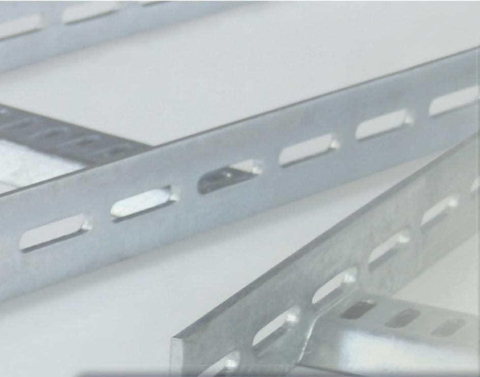
Эти лестничные лотки были разработаны специально для судостроения, однако они находят применение и в промышленности, а также при строительстве туннелей, строительстве электростанций и предприятий. Засчёт перекладин с пазами кабель можно фиксировать при помощи кабельных стяжек быстро и легко. Новая непрерывная перфорация по всей длине лонжеронов позволяет осуществлять крепление стеновых кронштейнов на винтах в желаемых местах без необходимости высверливания крепёжных отверстий.
