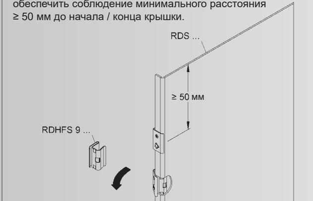
**6.** После завершения установки крышка RDS... защелкивается на предварительно смонтированных боковых частях STVSF 200... с помощью удерживающих пружин крышки RDHFS 9... .
