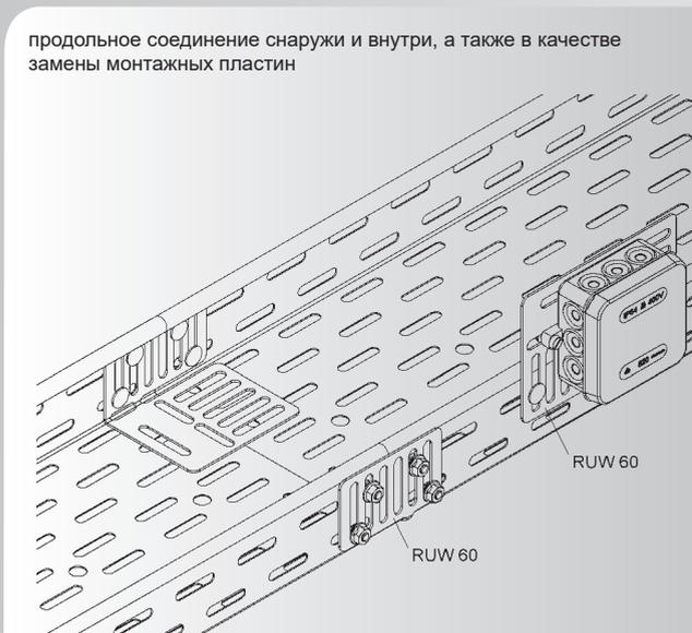
перекрещивающееся соединение в вертикальной плоскости
