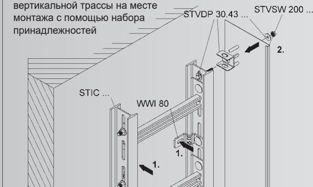
2. При креплении обшивок STVWA ... и STVFA ... к вертикальным трассам серии STIC... распорка должна быть расположена так, чтобы крепление можно было производить через перфорацию в задней части распорки.
