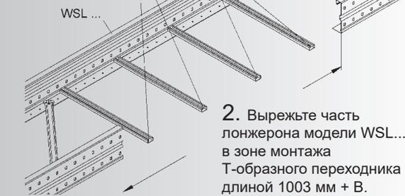
2. Вырежьте часть лонжерона модели WSL... в зоне монтажа T-образного переходника длиной 1003 мм + В.
