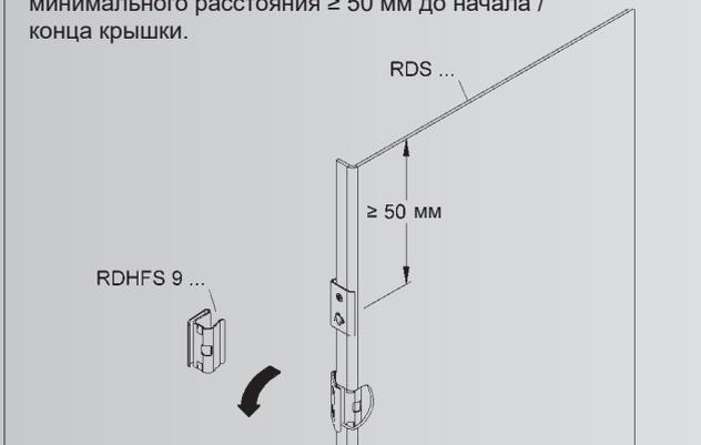
**4.** После завершения установки крышка RDS... защелкивается на предварительно смонтированных боковых частях STVSW 200... с помощью удерживающих пружин крышки RDHFS 9... .
