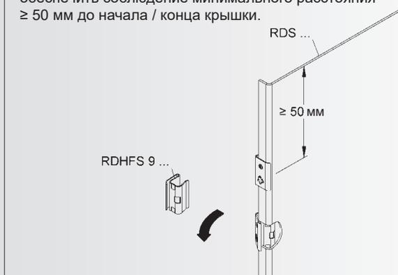
5. После завершения установки крышка RDS... защелкивается на предварительно смонтированных боковых частях STVSW 200... с помощью удерживающих пружин крышки RDHFS 9...
